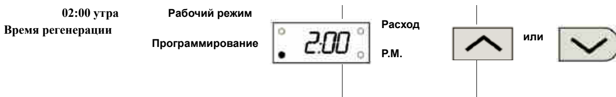
Рис. 5: Установка Времени регенерации
