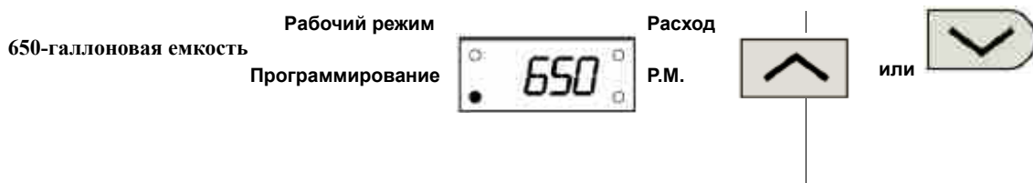
Рис. 4: Установка емкости обработанной воды
